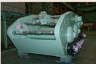
パースウィンチ Main tuna purse seine winch
