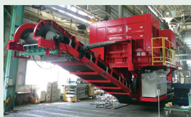
自走式破碎機搭載用発電装置 EG for mounting a self-propelled crusher Stage IV/Tire4 搭載(180kVA) 水冷式
