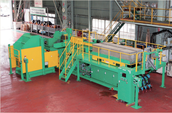
コンパクトビレットヒータ 800kW 2000Hz Compact billet heater 800kW 2000Hz
