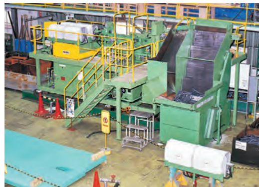
400kW 3/5kHz ビレットヒータ
