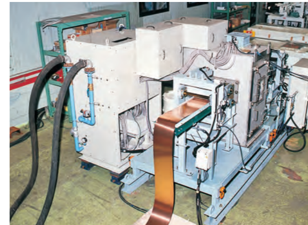
120kW 500 ~ 2000Hz 銅薄板加熱装置
