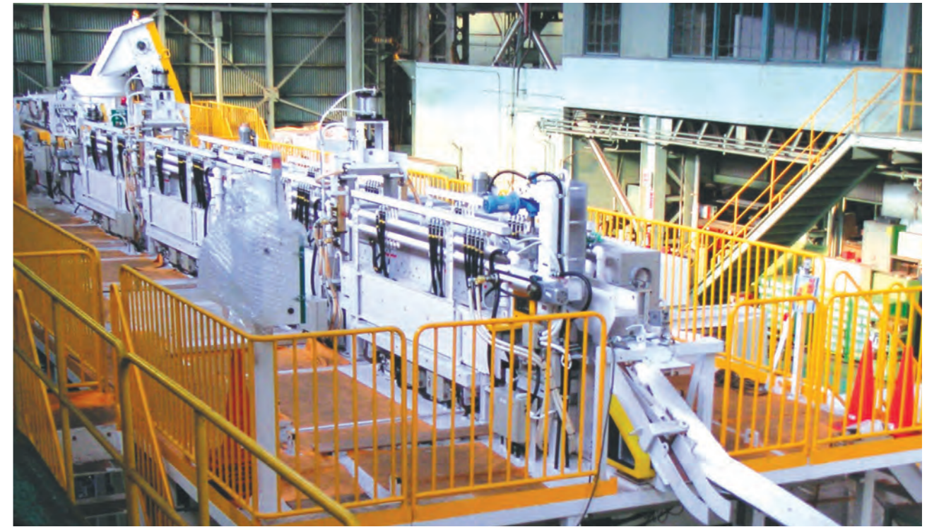
6000kW 0.7kHz/1.5kHz/3.0kHz ビレットヒータ
