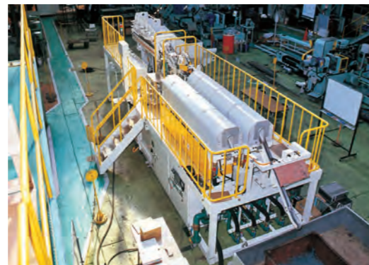
800kW 3000Hz ビレットヒータ
