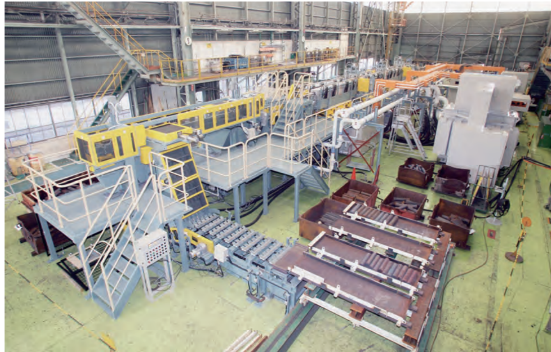
7000kW 700kHz ビレットヒータ
