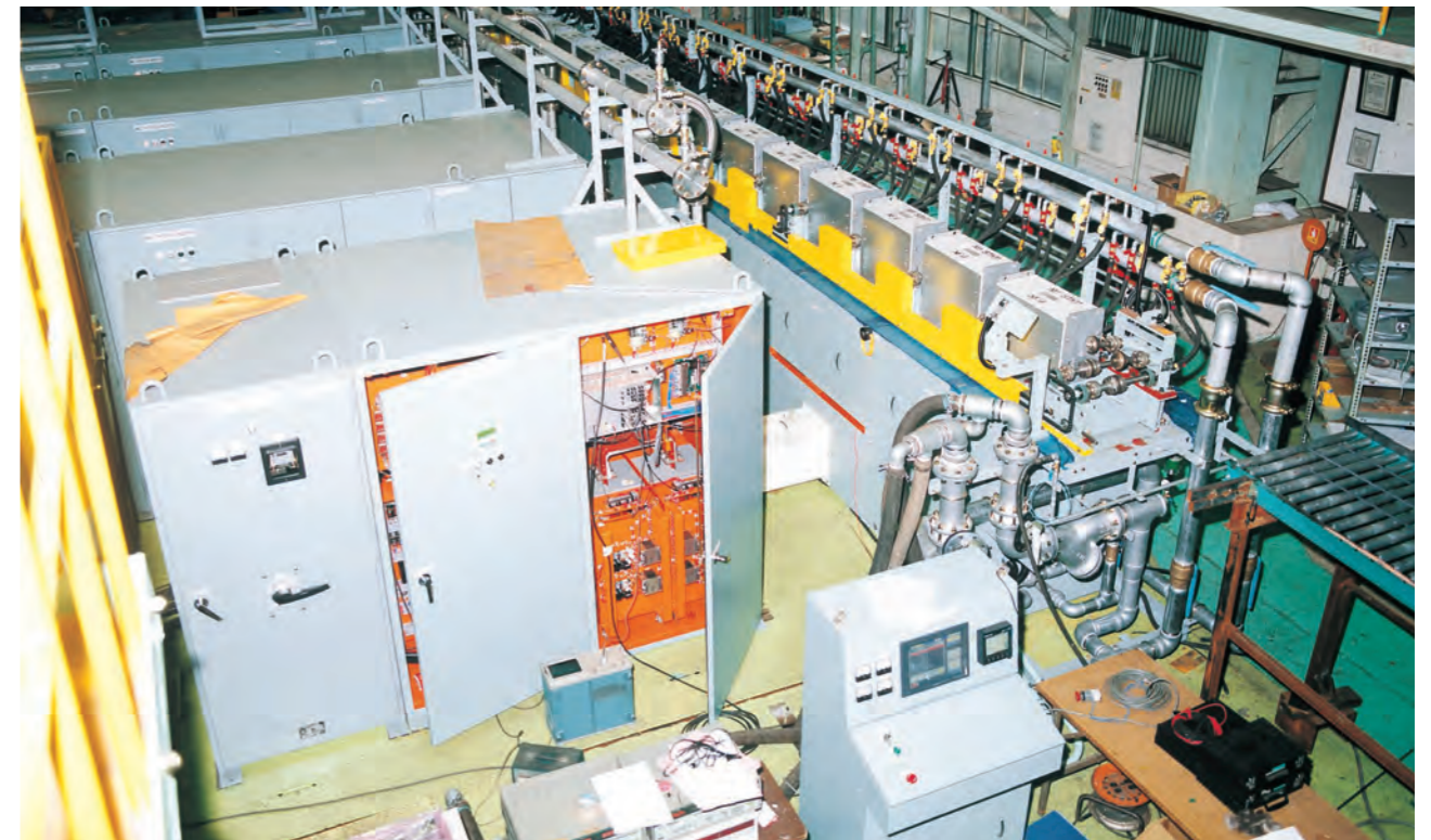
2750kW/10kHz + 365kW/50kHz 4電源線材連続QT装置
