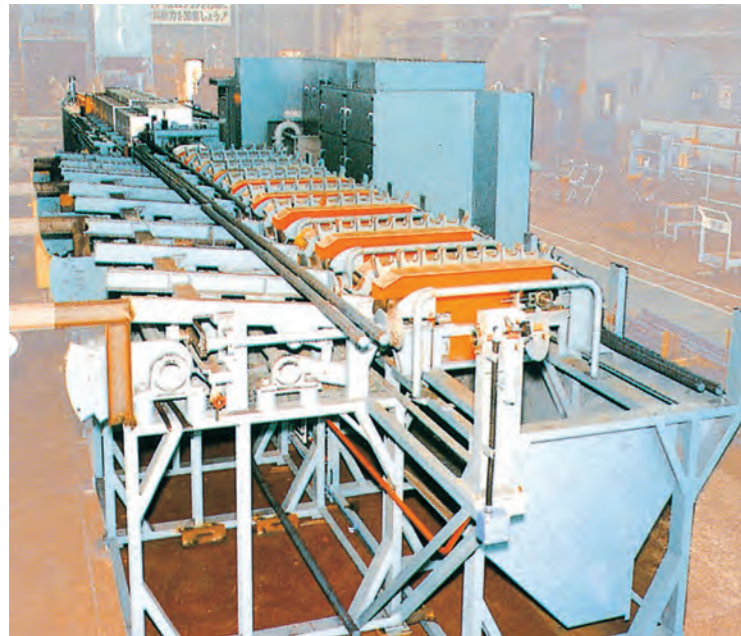
リターン材冷却装置
