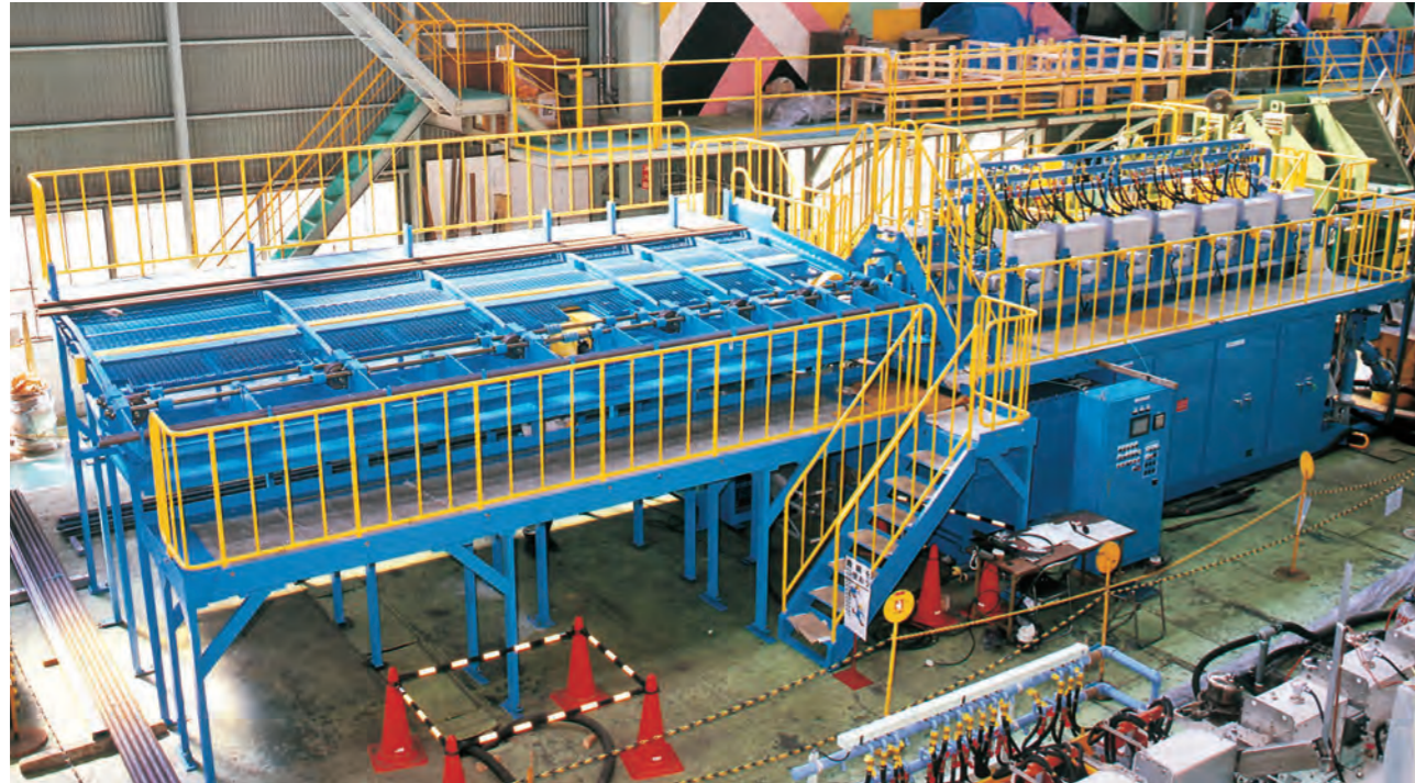
2000kW 3000Hz バーヒータ
