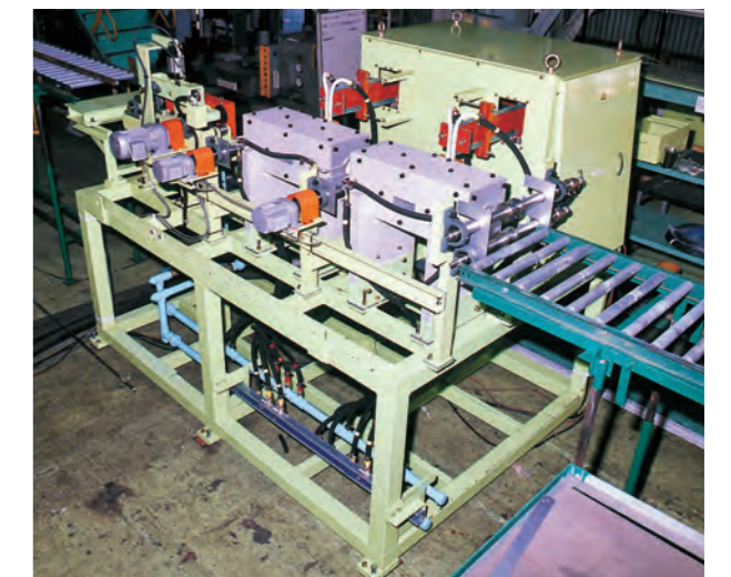
500kW 3000Hz シャー前バーヒータ
